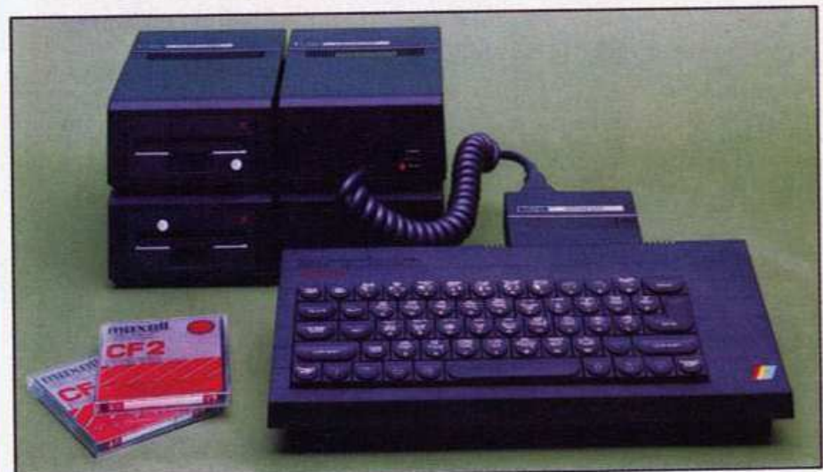
Passend im Design, macht das Timex-Diskettensystem aus dem Spectrum ein schmuckes »Schreibbüro« 20
